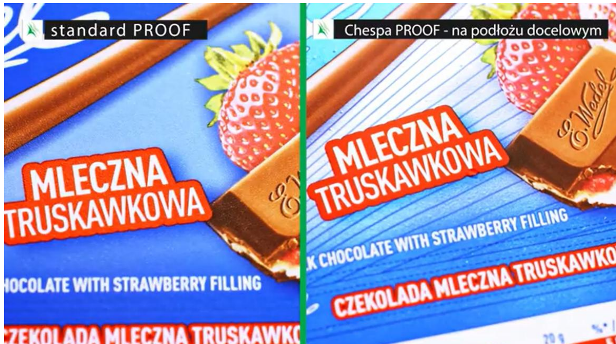
Rys. 2.12 Porównanie obu metod wydruków próbnych – widoczne paski w białej separacji
