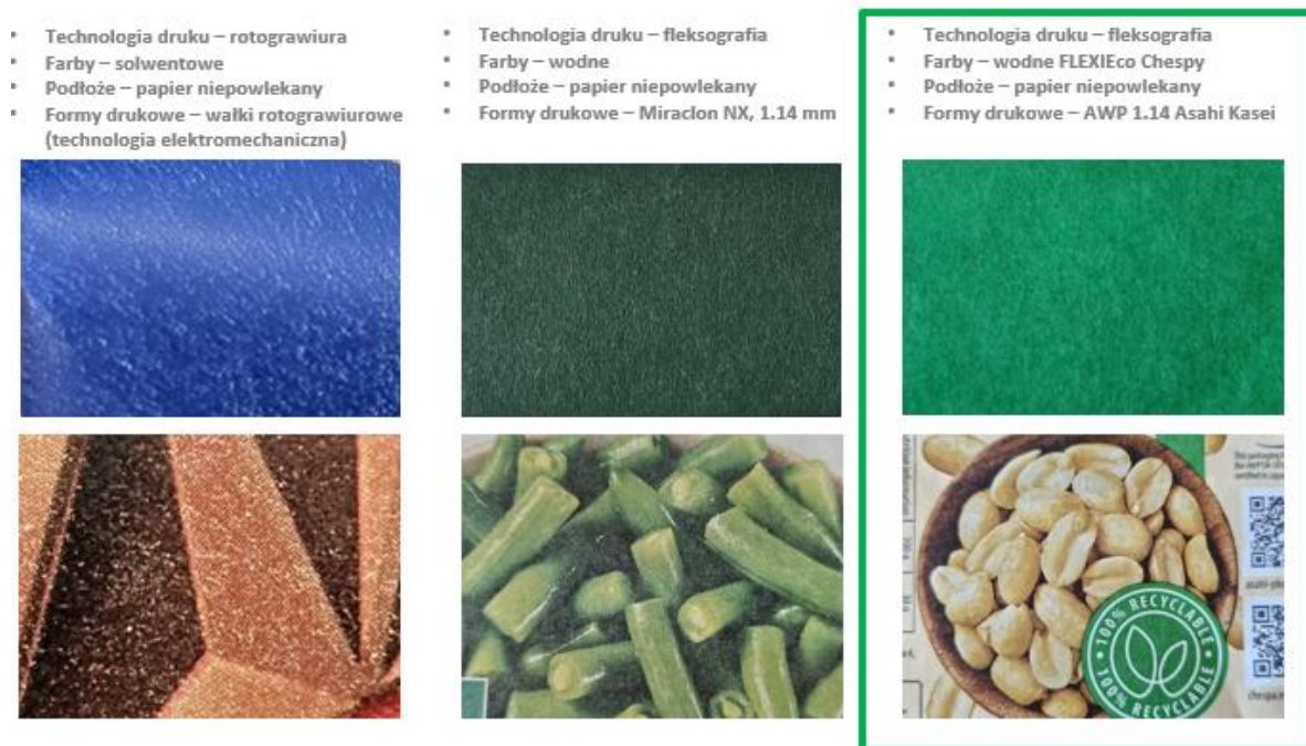
Rys. 9.8 Porównanie technologii fleksograficznych form fotopolimerowych, farb oraz technologii procesu drukowania na białym, niepowlekanym papierze
