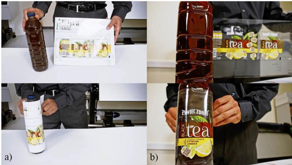
Rys. 2.10 Prezentacja wydruku próbnego na podłożu docelowym: a) wydruk próbny konwencjonalny, b) wydruk próbny na podłożu docelowym
