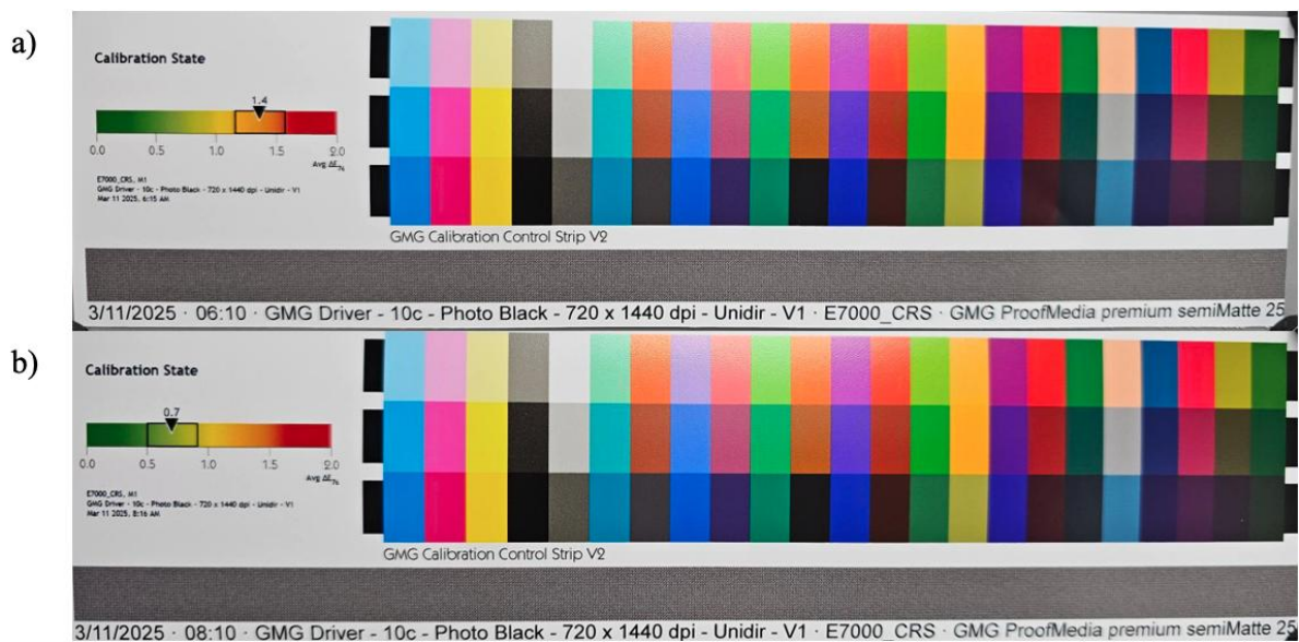
Rys. 2.8 Pasek kontrolny GMG Calibration Control Strip V2 z: a) nieprawidłową wartością deltyE, b) pasek kontrolny z prawidłową wartością deltyE
